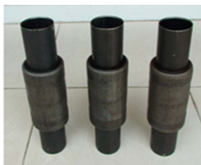
变直径圆管吸能元件
