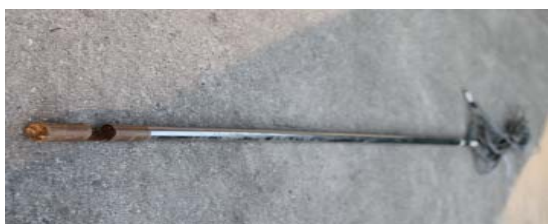
一体式超声波探针粉体浓度测试仪
