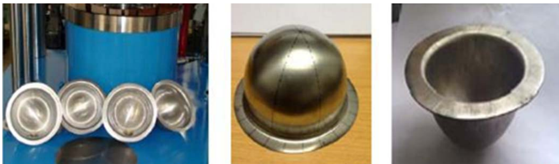
模具和拉深件（从左到右：铝合金、不锈钢和碳素钢板）
