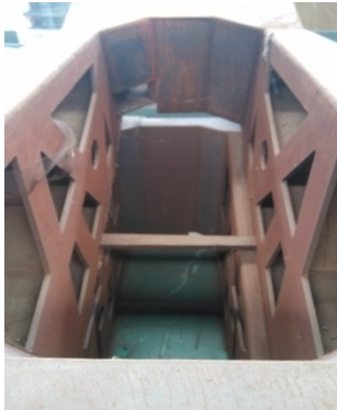
实际制造出来的机床内部立柱结构图
