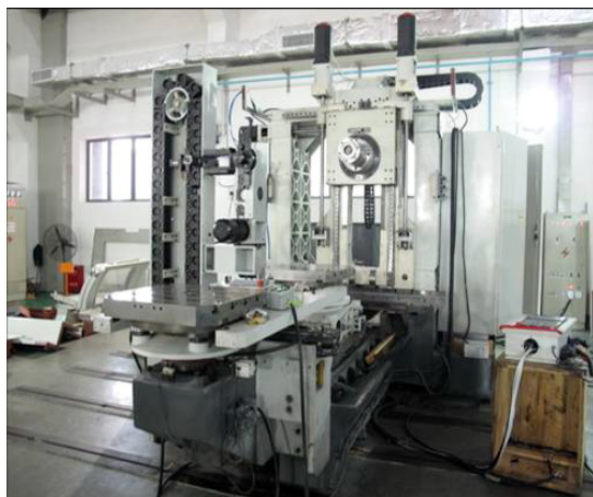
XH-630A 卧式加工中心的双驱机构
